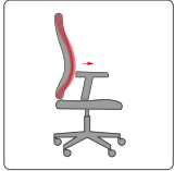
głębokość podparcia łędźwiowego BLS Tiefe der Lendenstütze BLS lumbar support depth BLS
